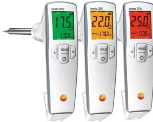
Figura 2. Analisador de qualidade do óleo de fritura Testo 270.
